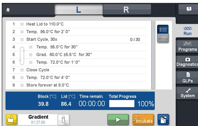
Hinweis: Bei peqSTAR 2X Doppelblock-Thermocyclern kann über die Reiter 'L' (links) und 'R' (rechts) der gewünschte Block ausgewählt werden. Bei den peqSTAR XS, 96X, 384X und in situ X Geräten steht diese Auswahl nicht zur Verfügung.
