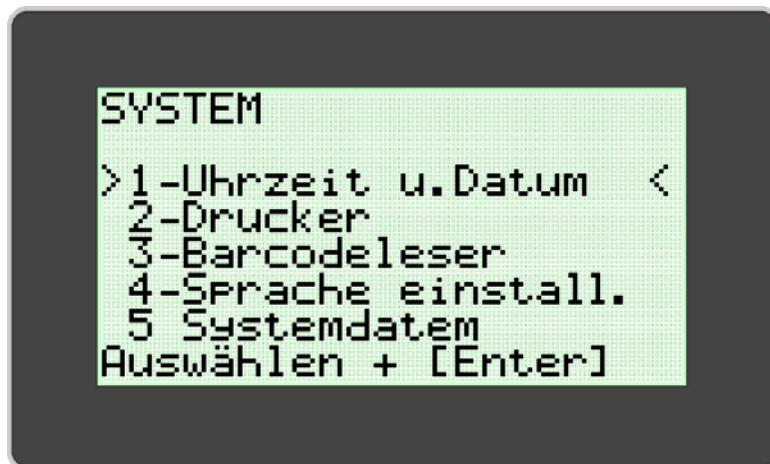
**HINWEIS:** Zeit und Datum können während eines laufenden Tests nicht geändert werden. Die Sprache kann während eines laufenden Tests nicht geändert werden.
