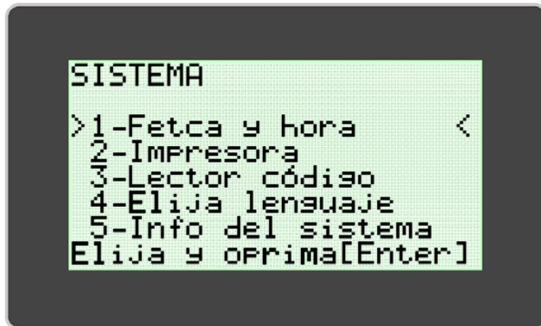
**NOTA:** La hora y la fecha no se pueden modificar cuando esté una prueba en marcha. El idioma no se puede cambiar cuando haya una prueba en marcha.
