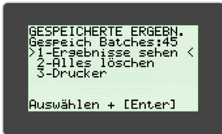
Der Benutzer kann durch Auswahl der Option „Ergebnisse anzeigen“ gespeicherte Ergebnisse anzeigen. Das Menü „Ergebnisse anzeigen“ ermöglicht dem Benutzer den Zugriff auf gespeicherte Daten, und zwar nach Datum und Block geordnet. Ausgewählte Chargendaten werden angezeigt und können manuell ausgedruckt werden, indem die Druckoption am Ende der Ergebnisanzeige ausgewählt wird.
