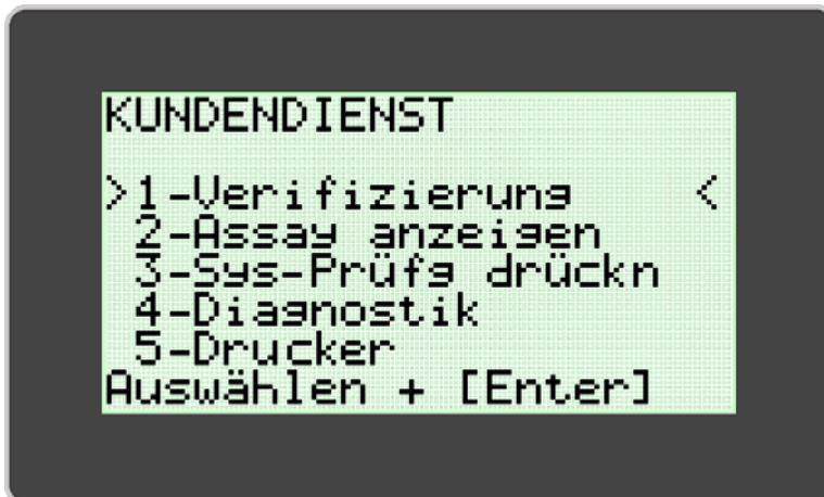
Die **OPTIKSYSTEM-VERIFIZIERUNG** ist erforderlich, um einen problemfreien Betrieb des **illumipro-10** zu gewährleisten. Anweisungen zur Ausführung der Optiksystem-Verifizierung sind im Abschnitt **KALIBRIERUNGSVERFAHREN** dieses Handbuchs enthalten.
