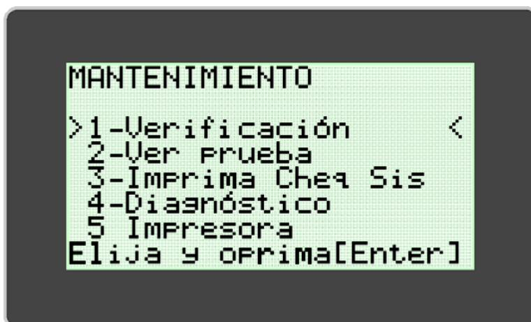
Es necesaria la **VERIFICACIÓN DEL SISTEMA ÓPTICO** para asegurar el funcionamiento correcto del **illumiPRO-10**. Las instrucciones para realizar la verificación del sistema óptico se encuentran el apartado **PROCEDIMIENTO DE CALIBRACIÓN** de este manual.
