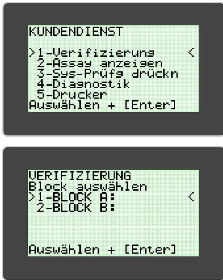
Die Optiksystem-Verifizierung besteht aus zwei Phasen. Die erste Phase stellt sicher, dass der optische Pfad klar und frei von Behinderungen ist. Die zweite Phase bestätigt, dass das optische System emittierte Lichtpartikel korrekt überträgt und nachweist. Übertragungs- und Nachweisverifizierung erfordern die Verwendung des **illumipro-10** roten Verifizierungsstandards. Das **illumipro-10** führt durch das Verifizierungsprotokoll und fordert den Benutzer nach Bedarf auf, zu agieren.
