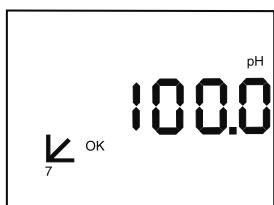
5. Das Messgerät zeigt die prozentuale Elektrodensteilheit beim ersten Puffer als 100,0 % an. Bei Eingabe des zweiten oder dritten Puffers führt das Messgerät einen Diagnose-Check der Elektrode durch und zeigt die aktuelle berechnete Elektrodensteilheit an.
