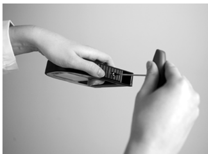
Abb. 11 - 2 Schraube für die Pumpenverriegelung entfernen
