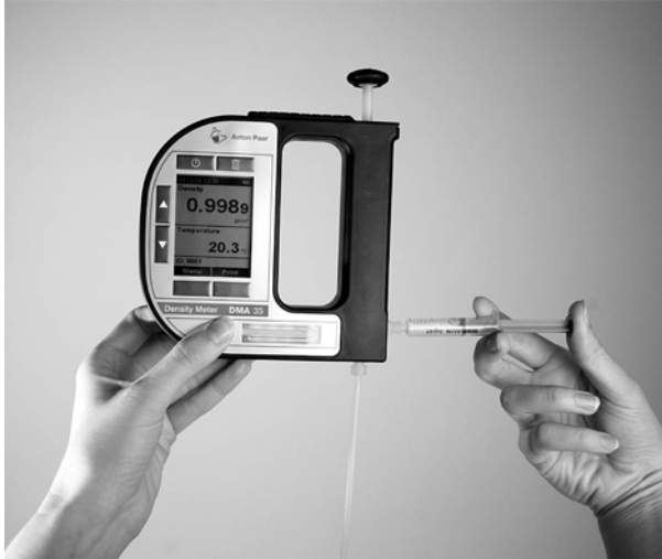
Abb. 9 - 2 Probe mithilfe einer Spritze einfüllen
